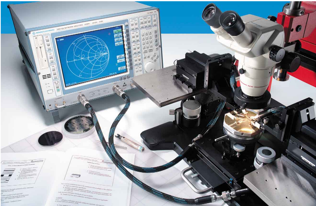
Die Rohde&Schwarz-Kalibriermethoden ermöglichen auch bei Messungen auf Wafern einfachste Handhabung und ein Höchstmaß an Genauigkeit (Vektorieller Netzwerkanalysator ZVM, Foto 43453-6)
