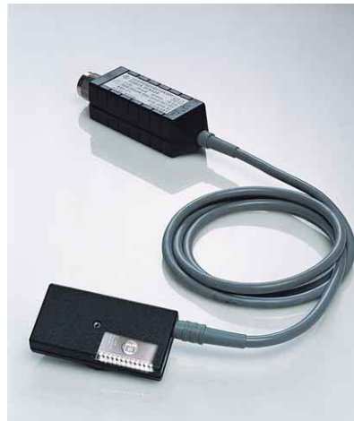
Die für eine individuelle Kalibrierung benötigten Daten sind für jeden Messkopf in einem EPROM im Anschlussstecker gespeichert (Foto 37902)
