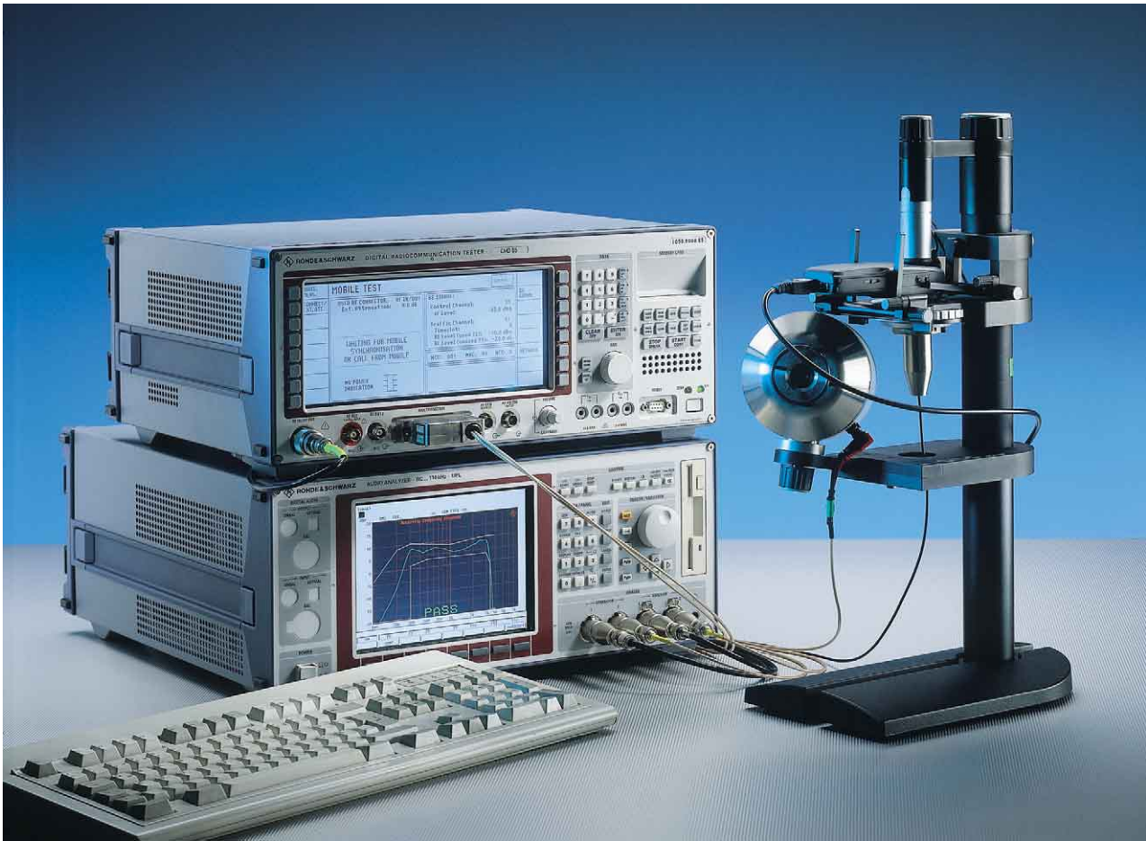
Audioanalysator UPL mit UPL-B7 für Messungen an Hörgeräten nach EN60118 oder ANSI S3.22 (Foto 43158-3)
